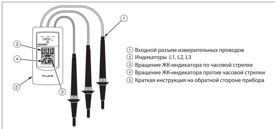
Рис. 1. Указатель порядка чередования фаз 9040
