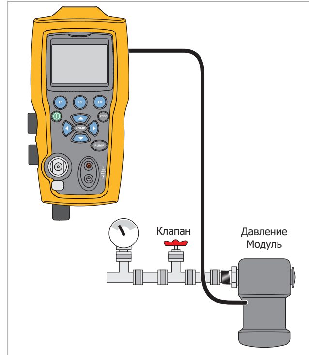
Рисунок 4. Измерение давления при помощи внешних модулей
